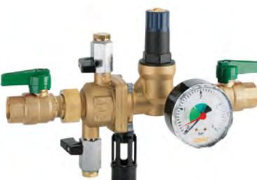
**Automatická plnící jednotka vytápěcích systémů s integrovaným zpětným a redukčním ventilem.** Odlučovač systému BA pracuje na tříkomorovém principu, což zabraňuje zpětnému vniknutí vytápěcích vod do pitné vody až do třídy rizika 4. Splňuje normu DIN EN 1717. Certifikovaný DVGW.
