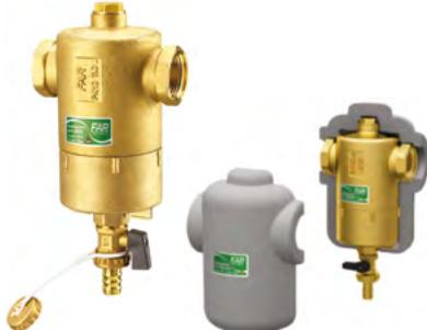
**Separátor nečistot s magnety a izolací** pro dimenze 5/4 col, 6/4 col, 2 col, odstraňuje magnetické i nemagnetické nečistoty, T<sub>max</sub> 110°C, P<sub>max</sub> 10 bar.
