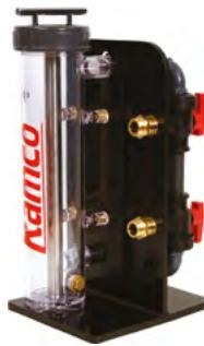
**Magnetický proplachovací filtr.** Filtr na rychlé a lehké odstranění cirkulujících černých oxidů železa z vody. Využívá sílu vzácných magnetů na přitáhnutí magnetických oxidů železa během čištění. Průhledné tělo filtru umožňuje kontrolu průtoku a zanesení filtru.
