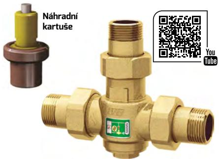
**Termostatický antikondenzační ventil proti kondenzaci.** Nezávisle reguluje teplotu vratné vody z nádrže teplé vody do palivového zdroje (kotle), zabraňuje kondenzaci na obvodě a dehtování. Dostupné provedení: 45 C, 55 C, 60 C, 70 C, 3/4 col, 1 col, 5/4 col.
