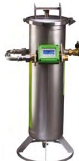
**Kompaktní přenosná jednotka na demineralizaci vody,** ideální pro prvotní plnění systémů, ale i na zabudování do systému, zařízení má integrovaný počítač pro kontrolu vyčerpání pryskyřice a sledování průtoku, na jedno naplnění umí upravit až 1200 l při 20° dH.
