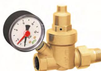
**Mosazný redukční ventil** pro zajištění konstantního tlaku pitné a užitkové vody v objektech od 1 do 6 bar. Zabraňuje tlakovým výkyvům z vodovodního řadu. Prodlužuje životnost vodovodních zařízení např. baterií, bojlerů, armatur a pod. Přednastavený na 3 bary.
