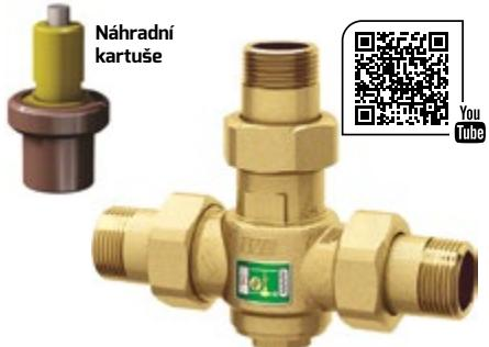
**Termostatický antikondenzační ventil proti kondenzaci.** Nezávisle reguluje teplotu vratné vody z nádrže teplé vody do palivového zdroje (kotle), zabraňuje kondenzaci na obvodě a dehtování.
