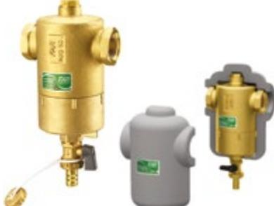
**Separátor nečistot s magnety a izolací** pro dimenze 5/4 col, 6/4 col, 2 col, odstraňuje magnetické i nemagnetické nečistoty, T<sub>max</sub> 110°C, P<sub>max</sub> 10 bar.
