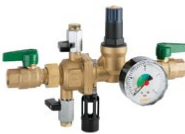
**Automatická plnící jednotka vytápěcích systémů s integrovaným zpětným a redukčním ventilem.** Odlučovač systému BA pracuje na tříkomorovém principu, což zabraňuje zpětnému vniknutí vytápěcích vod do pitné vody až do třídy rizika 4. Splňuje normu DIN EN 1717. Certifikovaný DVGW.
