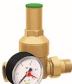
**Mosazný redukční ventil** pro zajištění konstantního tlaku pitné a užitkové vody v objektech od 1 do 6 bar. Zabraňuje tlakovým výkyvům z vodovodního řádu. Prodlužuje životnost vodovodních zařízení např. baterií, bojlerů, armatur a pod. Dodává se s regulačním klíčem.
